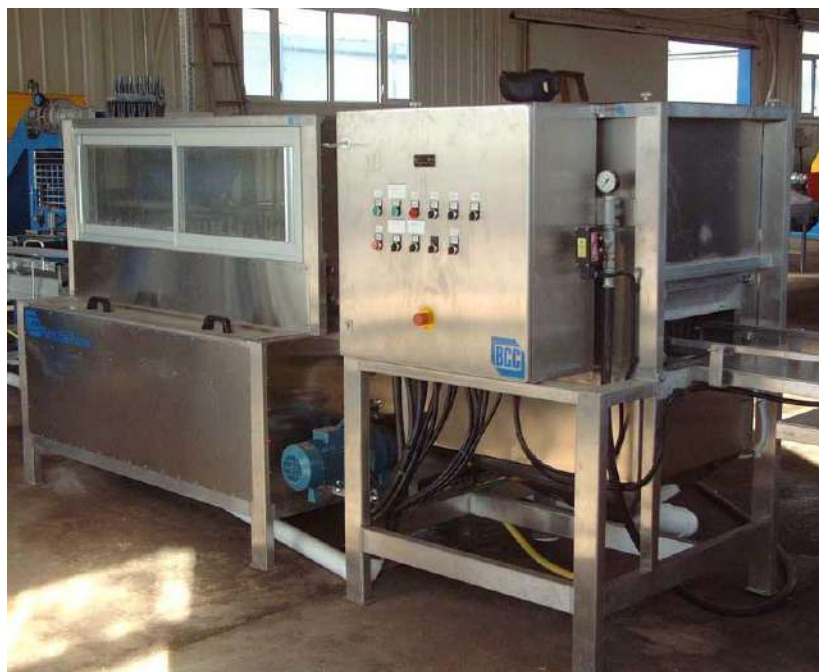
Рис. 1 Установка для мытья и дезинфекции кассет для выращивания сеянцев ВСС [19] Fig. 1 Installation for washing and disinfection of cassettes for growing seedlings BCC [19]
