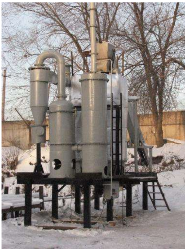
Рисунок 3. Комплекс для получения генераторного газа, г. Самара
