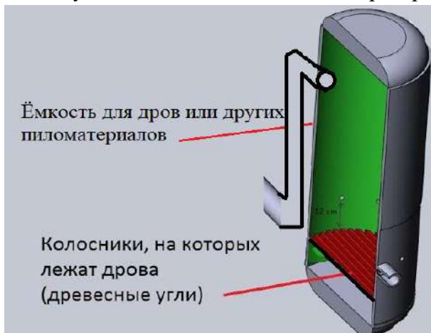
Рисунок 5. Вид самодельного газгена в разрезе
