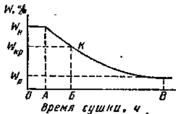
Рисунок 2. Изменение влагосодержания материала от продолжительности термообработки
