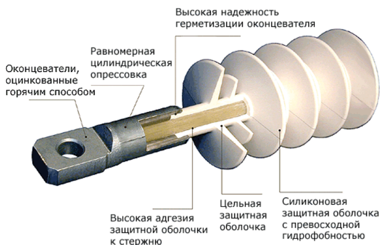
Рис 1. Полимерный изолятор
