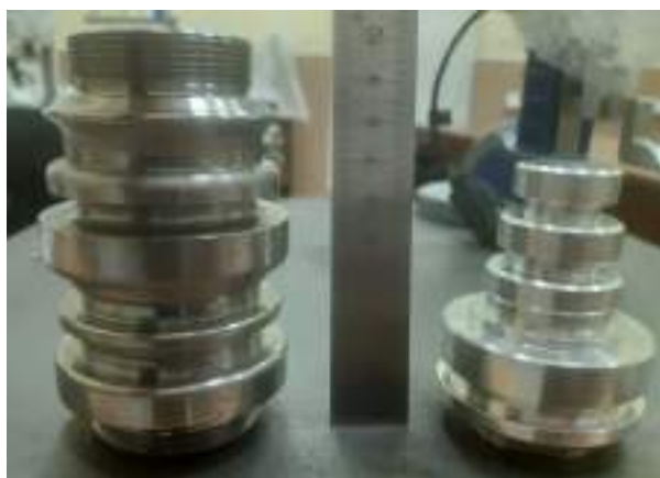
Рис. 3. Исследуемые детали: деталь массой 216,65г (справа, сплав Д16Т) и 732,6 г (слева, марка стали Ст45)
