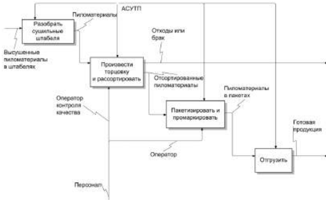
Рис. 3. Декомпозиция процесса сортировки сухих пиломатериалов
