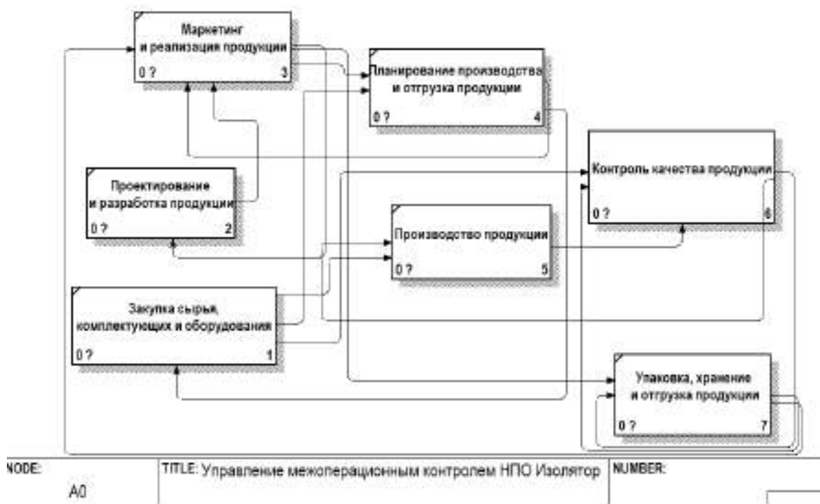
Рис. 3. Декомпозиция процесса управления межоперационным контролем
