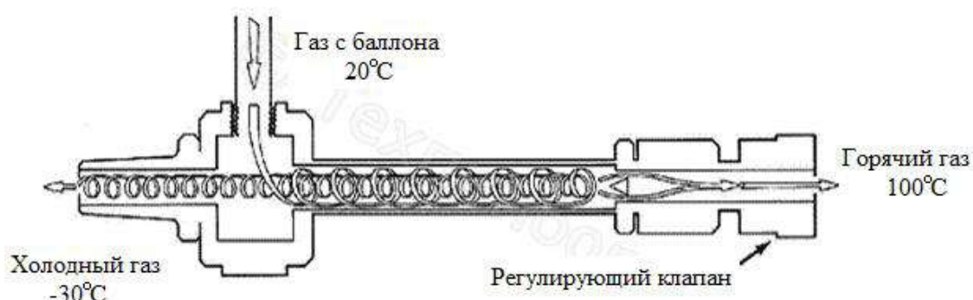
Рис. 2. Схема двухпоточной вихревой трубы.
