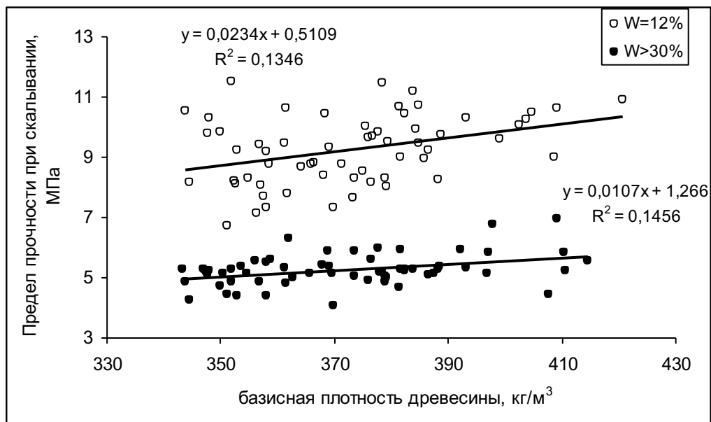
Рис. 1. Зависимость прочности при скалывании в тангенциальной плоскости от базисной плотности древесины ольхи серой.
