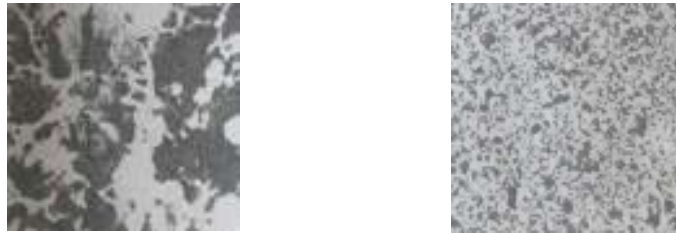
Рис. 1 Структура стали: а) – до ТЦО, б) – после ТЦО
