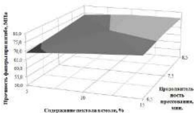
Рис. 1. Зависимость прочности фанеры при статическом изгибе от содержания пектола в смоле и продолжительности прессования
