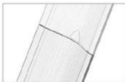
Рис. 3. Неидеальный стык наклонных плит
