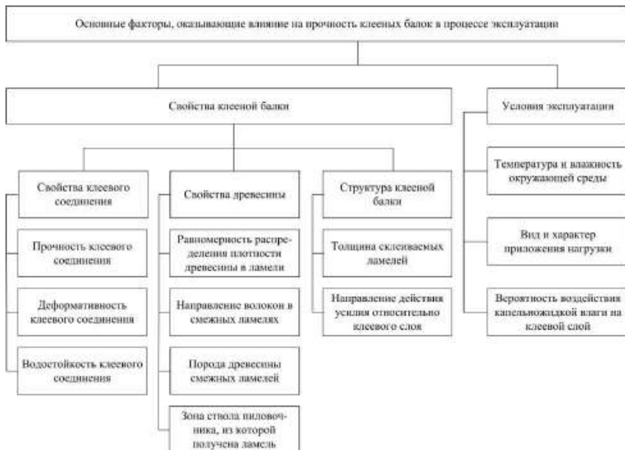
Рис.2. Факторы, влияющие на прочность клеевых соединений древесины в процессе эксплуатации
