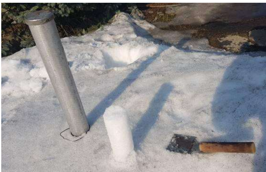
Рис. 1. Снегомер – плотномер и образец отобранного снега.
