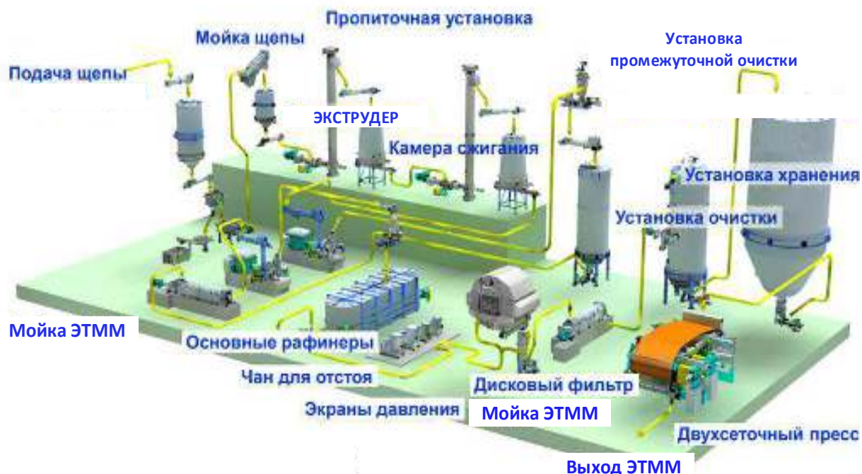
Рис. 1. Технологическая схема производства ЭТММ
