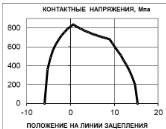
Рис. 2. Контактные напряжения 1-й и 2-й ступени редуктора Ц2У-250
