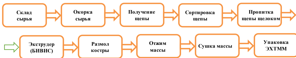
Рис. 1 Схема производства экструзивной химической термомеханической массы из древесины.
