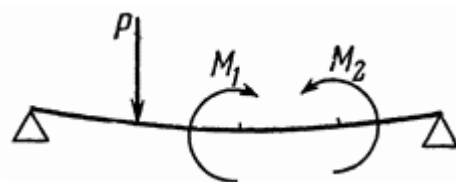
Рисунок 5. Приложение моментов к балке.
