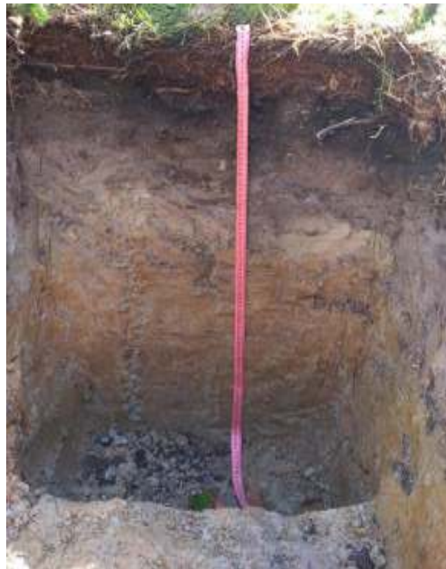
Рисунок 4. Почвенный разрез торфяно-элювиально-метаморфической окислено-глеевой глинисто-иллювирированной потечно-гумусовой легкосуглинистой почвы на ленточных глинах (осушенный участок)
