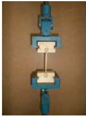
Рис. 3 – Позиционирование образца в зажимах испытательной машины
