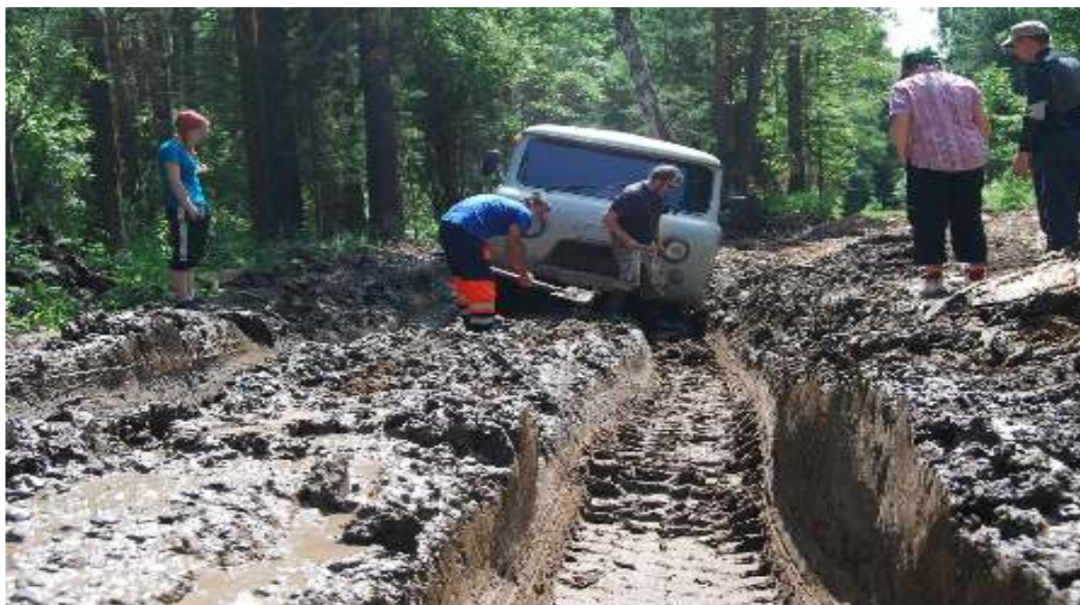
Рис. 2 Колея образованная после проезда гусеничных лесозаготовительных тракторов в СевероЕнисейском районе Красноярского края
