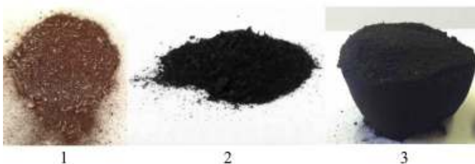
Рис. 1 – Гидролизный лигнин (1), уголь-сырец из него (2) и гранулированный уголь-сырец из модифицированного гидролизного лигнина (3)
