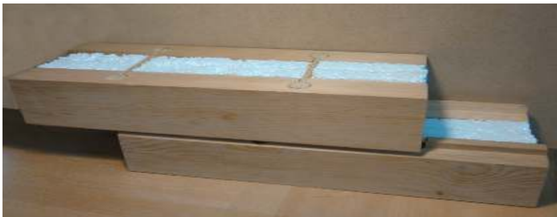
Рис. 4 – Макет соединения стеновых элементов слоистой вставкой
