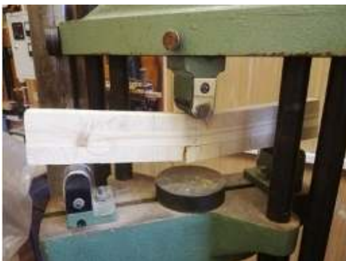
Рис. 1. Испытание образцов на изгиб поперек волокон на базе кафедры ЛТ8-МФ МГТУ им. Н.Э. Баумана, Мытищи 2019
