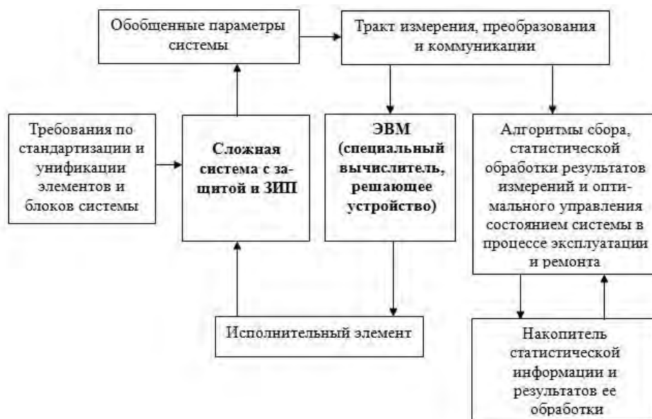
Рис. 2 Структурная схема автоматической эксплуатации сложного технического объекта
