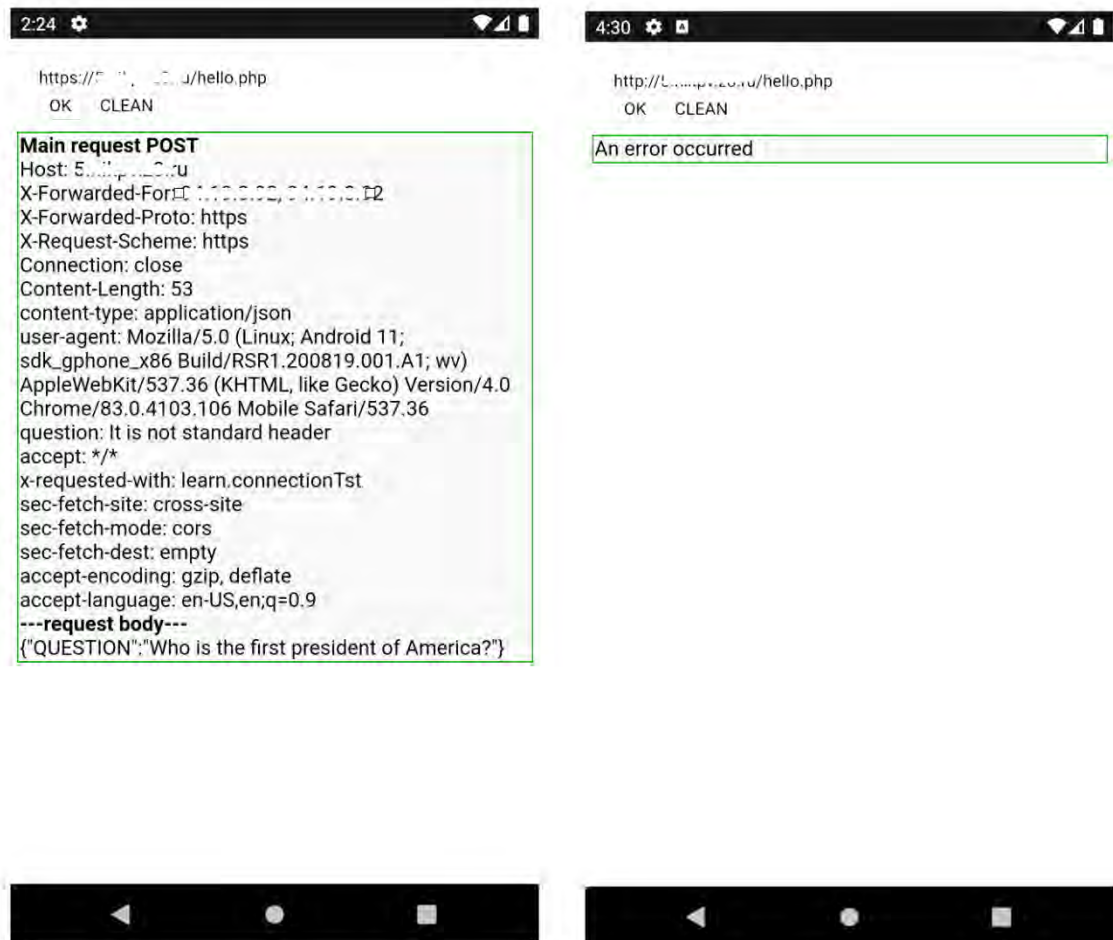
Рис. 3 Результат теста для мобильной платформы Android. Запрос с использованием открытого протокола http блокируется. Для кросс-доменных запросов используются заголовки fetch metadata request headers ( https://w3c.github.io/webappsec-fetch-metadata/ )
