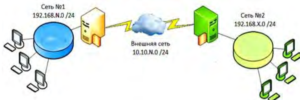
Рис. 1. Общий вид настраиваемого межсетевого объединения
