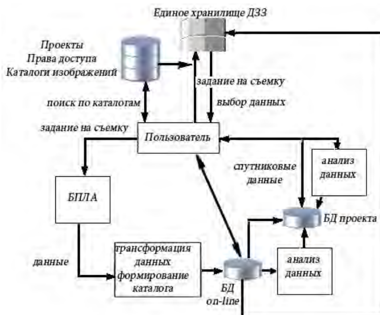
Рис. 6. Схема взаимодействия пользователя с хранилищами данных ДЗЗ
