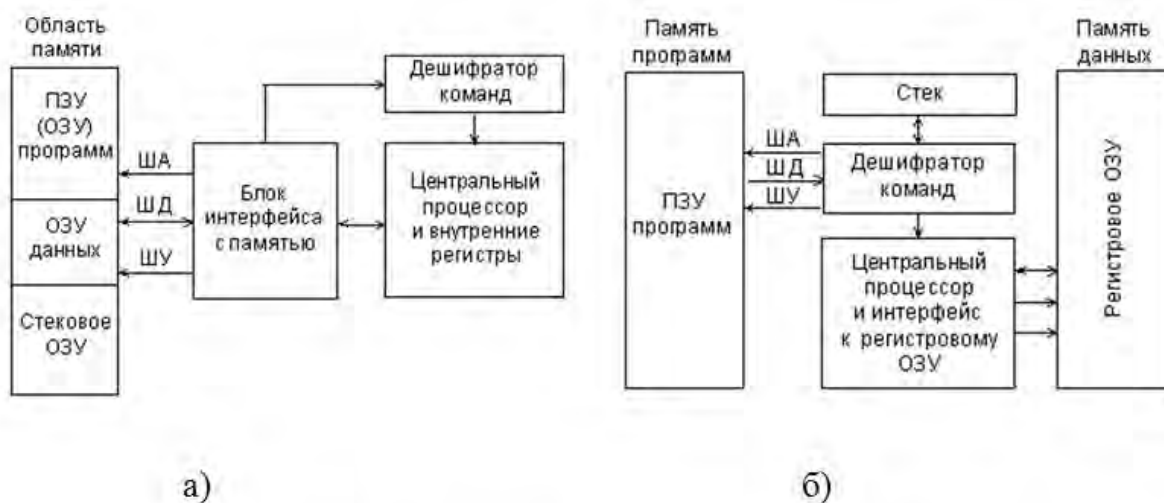
Рис1. Классическая архитектура а) фон Неймана, б) гарвардская http://www.intuit.ru/studies/courses/3/
