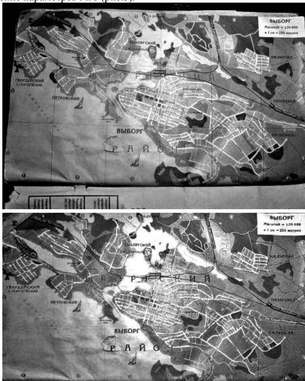
Рис.5. Результат коррекции картографического изображения при помощи билинейного преобразования координат
