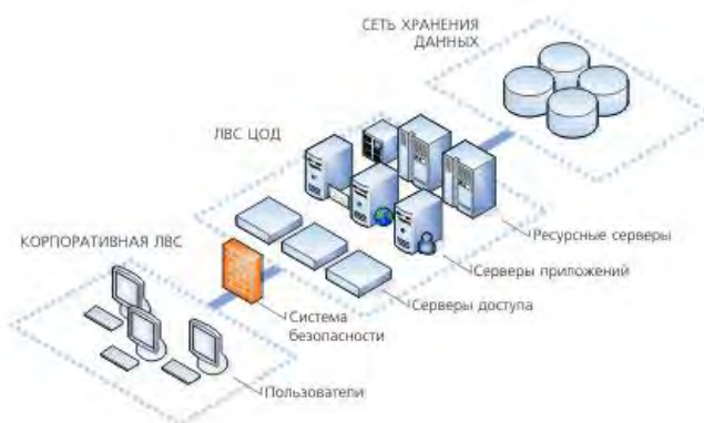
Рис.1. Типовая структура центра хранения и обработки данных
