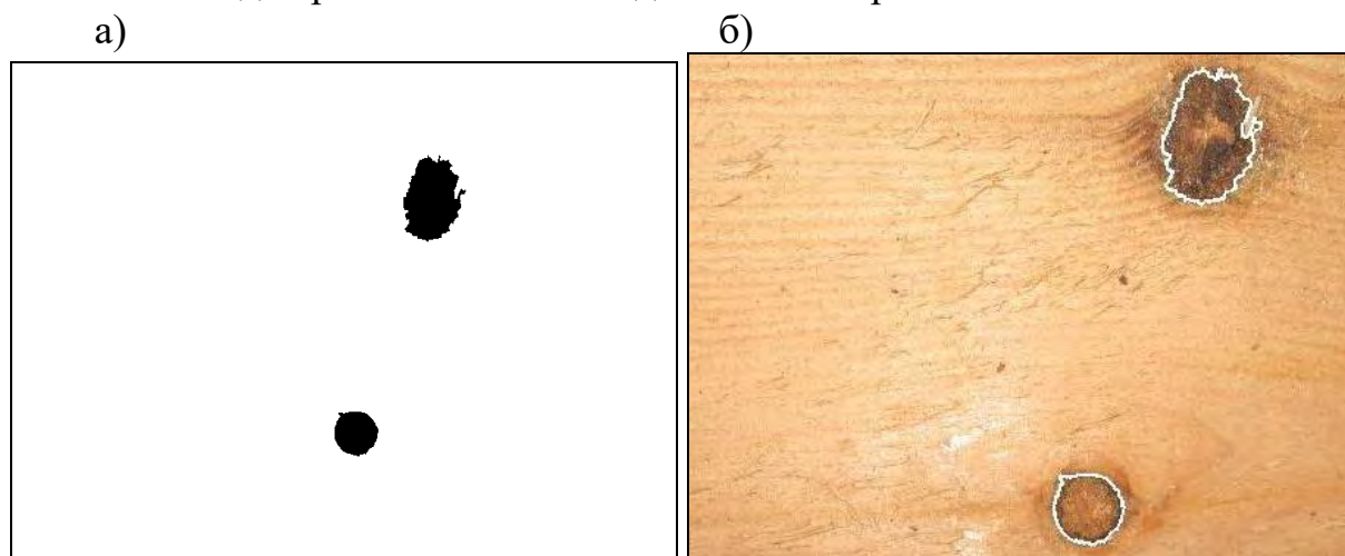
Рис. 4. а - заливка отверстий и б - вычисленные границы дефектов на поверхности п/м
