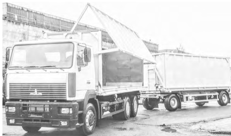
Рис. 5. Автопоезд-щеповоз в составе трехосного автомобиля типа 6×4 и двухосного прицепа с суммарной емкостью кузовов от 60 до 80 насыпных куб. м. с разгрузкой вбок.
