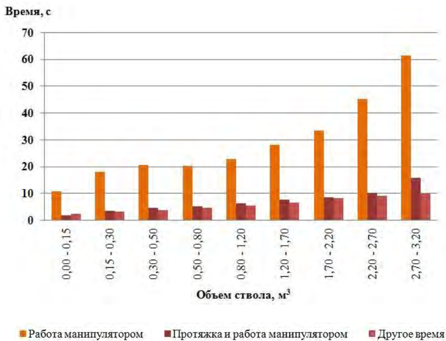
Рис. 3 Влияние объема ствола на время обработки отдельных операций: а) - оператор А; б) - оператор Б
