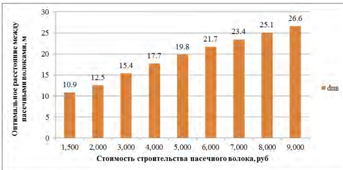
Рисунок 9 – Диаграмма зависимости стоимости строительства пасечного волокна на расстояние между ними
