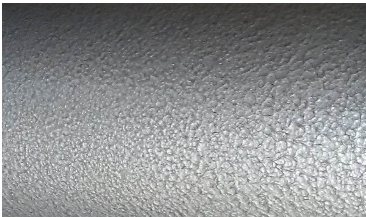
Рис.3. Поверхность образца «после» очистки установкой типа КСО-130-И-ФВ-М
