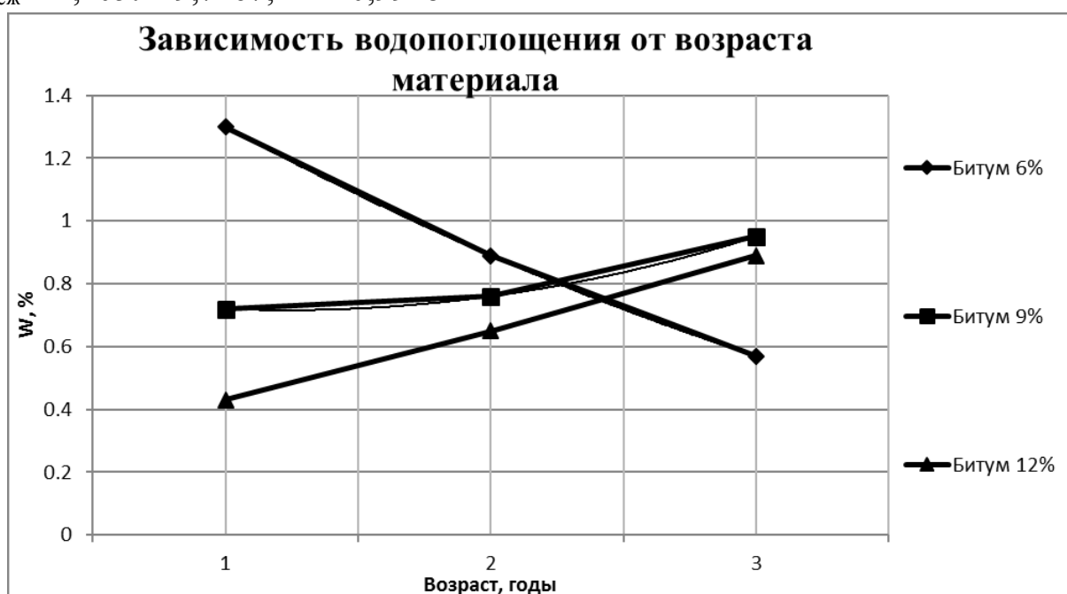
Рис.2. График зависимости водопоглощения золопесчаной смеси, укрепленной вяжущими, от возраста материала.
