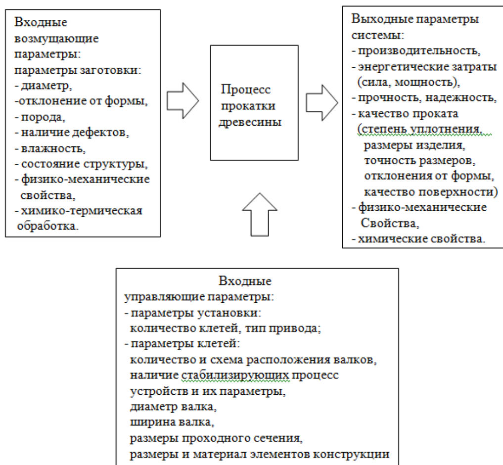
Рис. 2. Процесс прокатки древесины как управляемая технологическая система.
