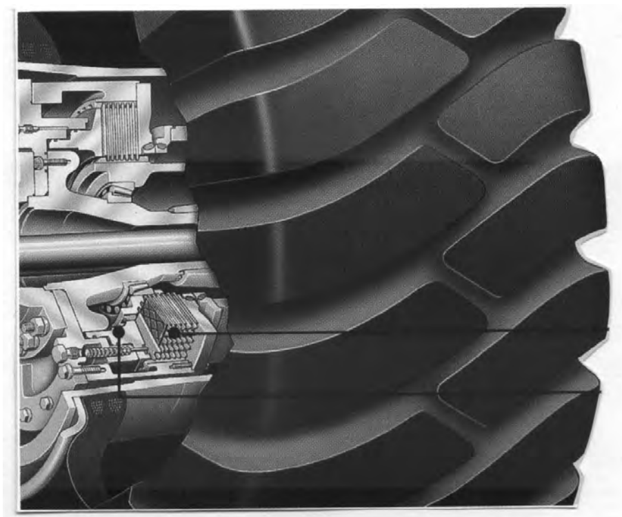
Рис. 2. Многодисковый тормоз, работающий в масляной ванне
