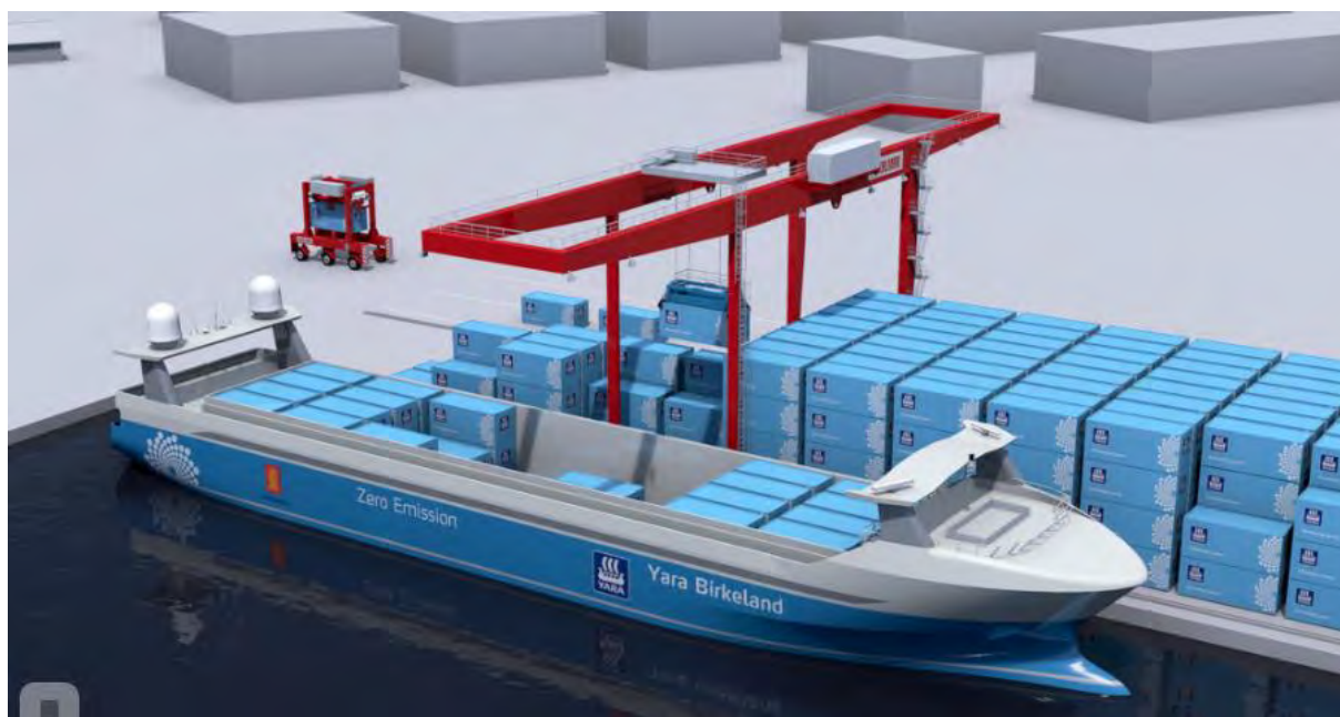
Рис. 4. Беспилотный контейнеровоз Yara Birkeland
