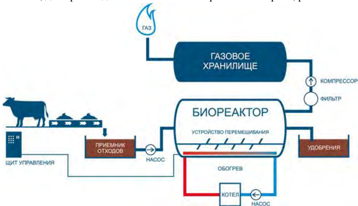
Рис. 1. Схема биогазовой установки
