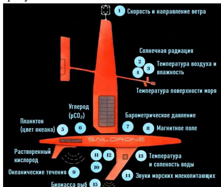
Рис. 2. Размещение датчиков для сбора информации лабораторией Saildrone
