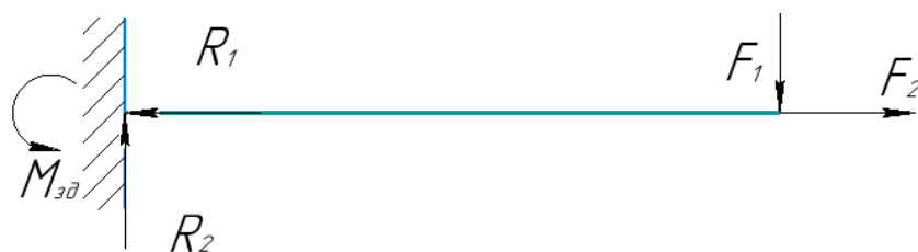
Рис. 2. Расчётная схема приложения сил и моментов сил. ( F_1 = F_2 = 3000 Н)
