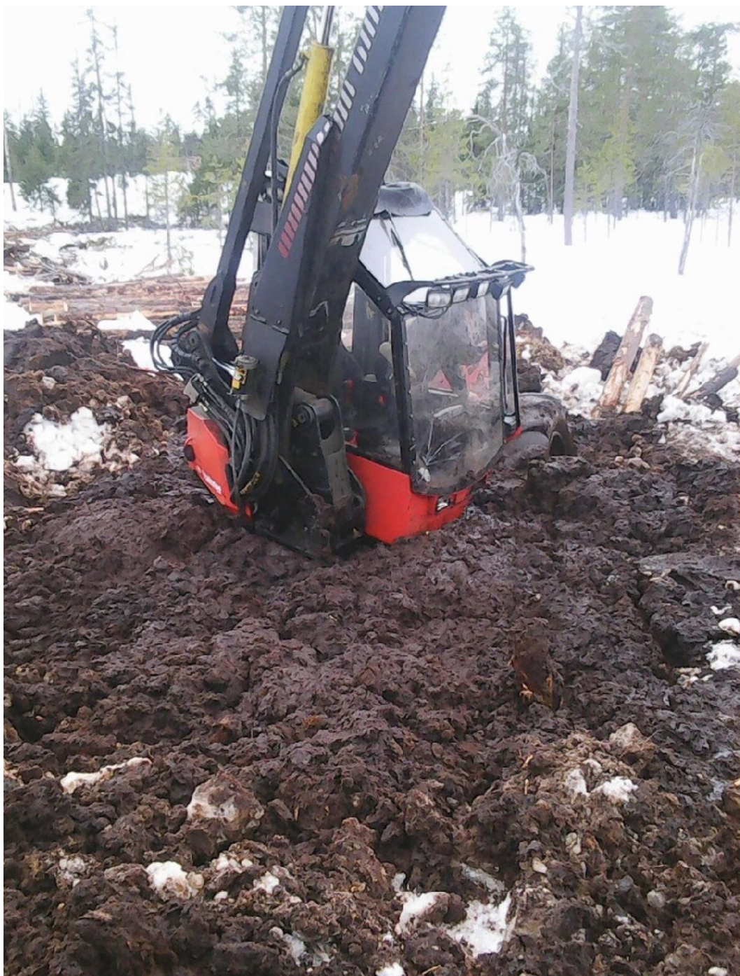
Рис. 1. Невозможность применения существующей техники и технологии для заготовки древесины в СЗФО РФ из-за климатических условий
