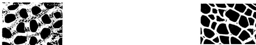
Рис. 1. Микрофотограммы поперечного среза (увеличение в 200 раз): а – древесина березовая б – уголь из древесины березовой
