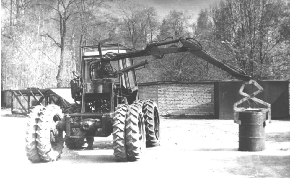
Рис. 4. Экспериментальный образец для погрузки круглой тары
